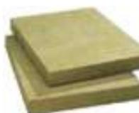
Panneau d'isolation double densité non revêtu en laine de roche avec capacité isolante améliorée pour l'isolation des façades sous enduit. Certifié ACERMI. Format : 60 x 120 cm.
