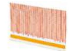
Profilé en plastique avec renfort en fibre de verre et goutte d'eau à encastrer sur le Profilé de départ. Pour limiter le risque de fissures dans la zone d'union des profilés de départ et réaliser une finition nette. Largeur du renfort : 12,5 cm
