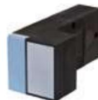
Équerre de fixation de charges moyenne en PU haute densité (250 kg/m<sup>3</sup>) renforcée d'acier. Idéale pour la fixation sans pont thermique d'éléments en tableau de baie (par ex. un garde corps).
