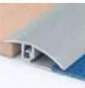
Comprend 2 parties : une base percée en alu brut à visser ou à coller au sol et un chapeau à clipser sur la base. Possibilité d'incliner le chapeau pour rattraper les différences de niveau.
